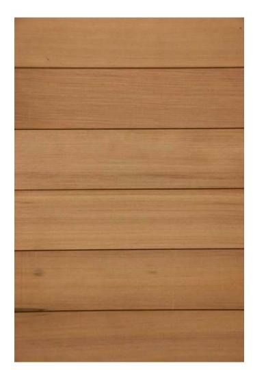
HORIZONTAL WOOD SIDING -CLEAR FINISH TYPE HW-1
